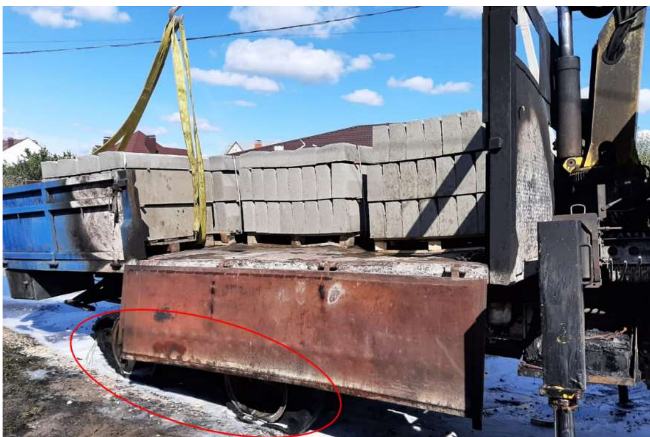
Место несчастного случая (следы прохождения тока короткого замыкания).
